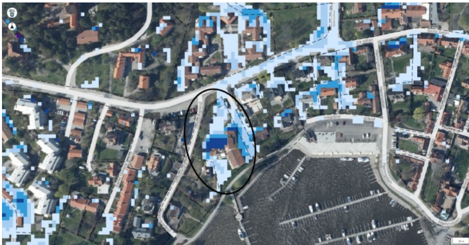
Beräknade maximala vattendjup (m) för ett 100 års regn med klimatfaktor 1,25.
